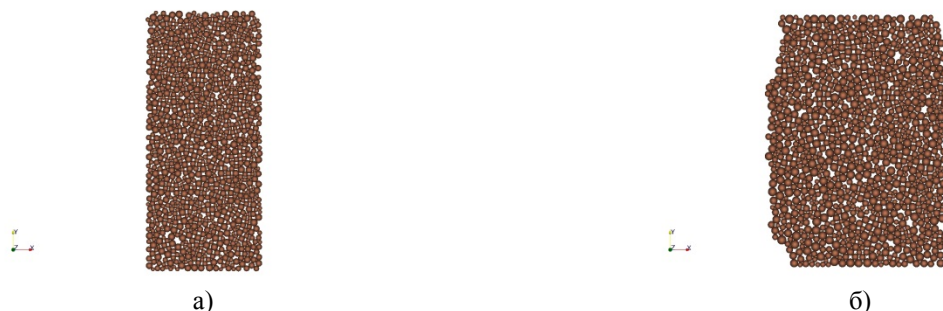
Слика 2.1.2.1. Биаксијално сабијање грануларног материјала а) недеформисано стање, б) стање модела на крају, прорачуна
